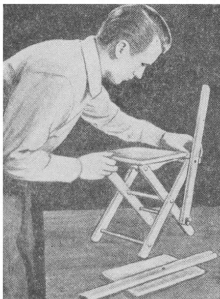
Рис. 4. Соединение ножек с брусками спинки.
